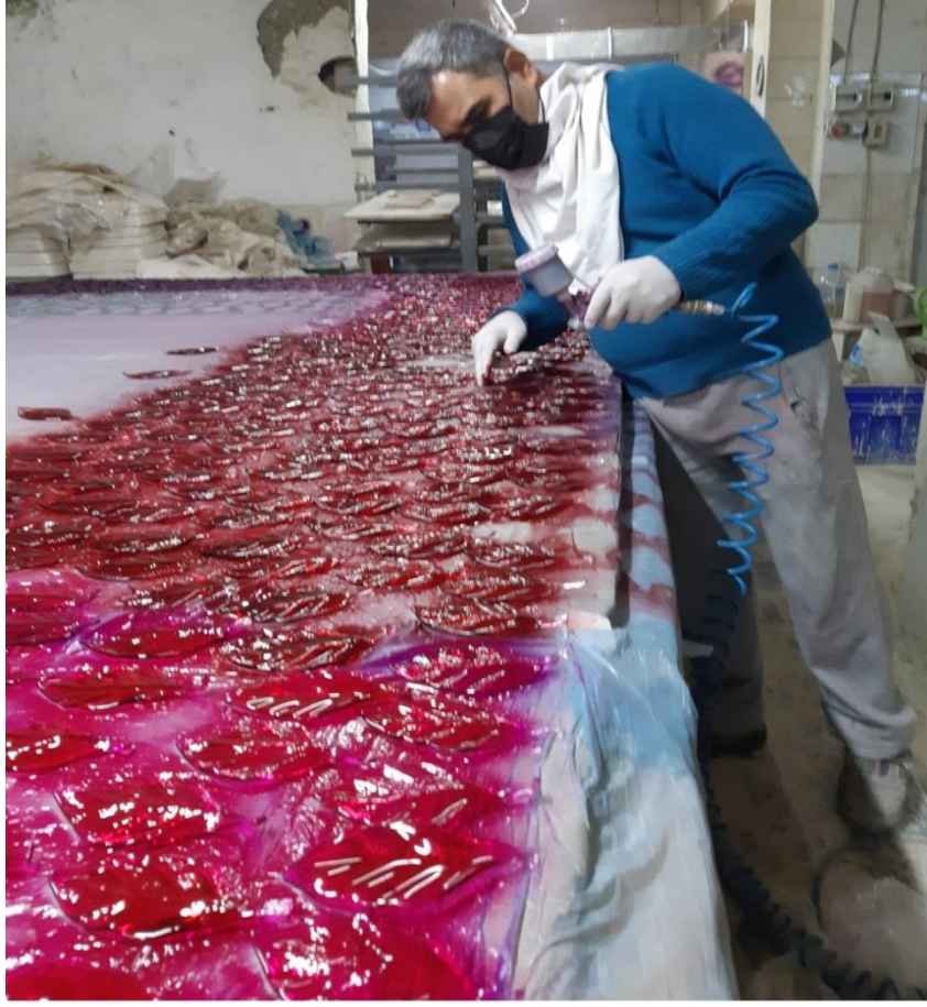
Resim 4; Şekillendirilen camların Pistole tabancası ile boyanması. Fotoğraf, Kamuran Karaağaç arşivi.
