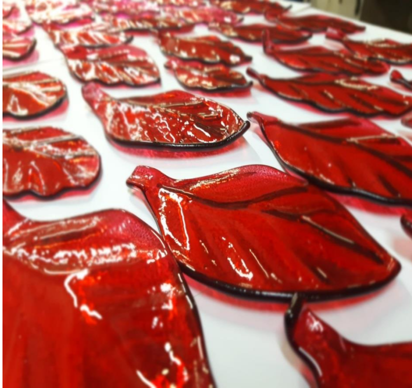
Resim 6; Şekillendirilen camların boyanması sonrasında uygun derecede ve zaman aralığında fırınlanması. Fotoğraf, Kamuran Karaağaç arşivi.
